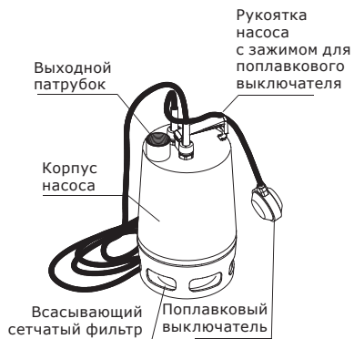
Рис. 1 Конструкция насосов APV.06 / APV.40 V
