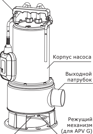
Рис. 3 Конструкция насосов APV.40B/45B/ 50B V/G
